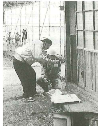
下げ振りで傾斜を計測する判定士
