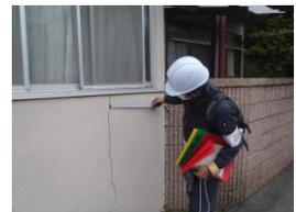
・下げ振りを使用し、建築物の傾斜を測定します。
